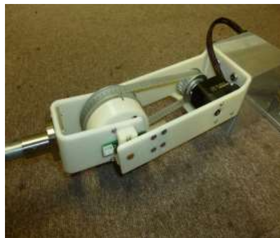
Fig.2 試作したロボットの肘関節
