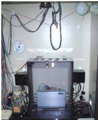
図1：学習課題の装置 中央の透明アクリル性のボックス内でラットが学習課題を行う。箱の向こう側に課題制御用のインターフェースがあり、箱の左側には報酬用ペレットを出すディスペンサーがある。装置全体は防音シールドボックス内に置かれ、その天井には音刺激提示用のスピーカーと、マルチニューロン活動導出用のヘッドアンプ付きケーブルがある。
