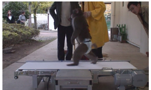
Fig. 5. 床反力計を埋め込んだトレッドミル上を歩行するニホンザル
