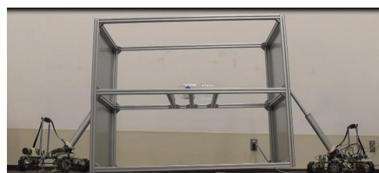
図3 2台のロボットによる重量物の傾け操作
