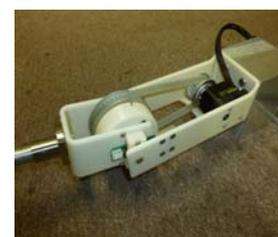
Fig.5 試作したロボットの肘関節
