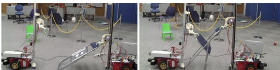
Fig.3 2台の移動ロボットによる折り畳み椅子展開実験
